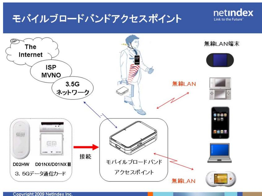
図1. モバイルブロードバンドアクセスポイント「クティオ」の利用イメージ
